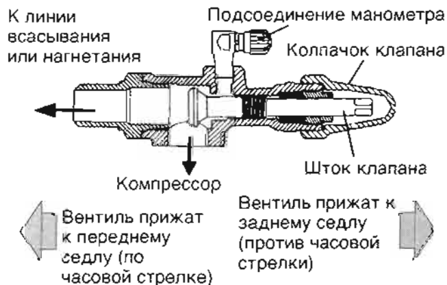
Рис. 6-3. Вентиль обслуживания на линии всасывания или нагнетания
